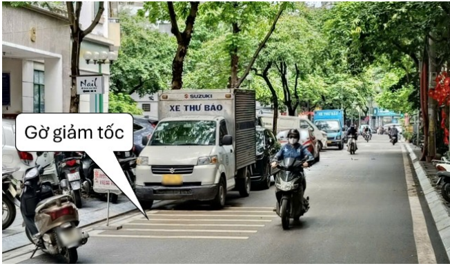
a) Gờ giảm tốc nửa phần đường (1 chiều đi)
